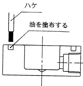
(2)カバーに端面シール㉑を図のように装着してください。
