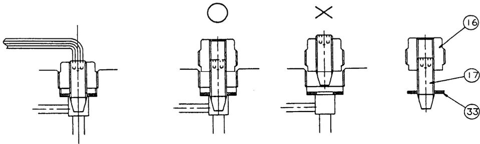
(1)クッションバルブ⑰をクッションバルブシール⑳から抜けない程度クッションプラグ⑱をゆるめます。
