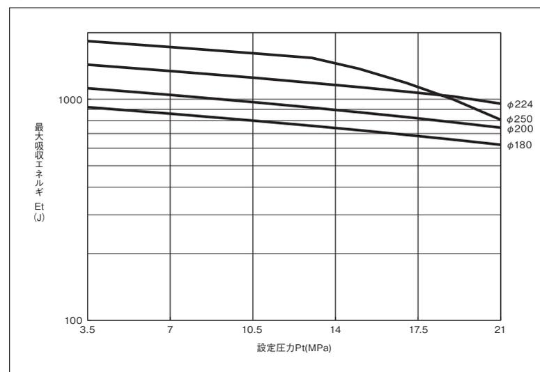
**PTT-2B B ロッド ロッド側最大吸収エネルギー**
