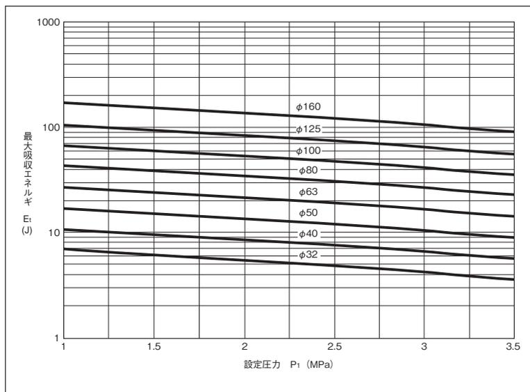
100H-2のクッション突入時の外力-エネルギー変換図
