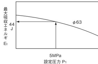
4.  $E_1 + E_2$  が最大吸収エネルギー  $E_t$  以下であるか確認する。
