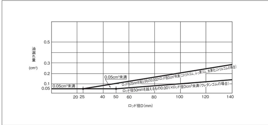
外部油漏れは、ロッドのワイバ部からの油漏れをピストンの移動距離100mの総量で表します。(JIS B8367参考)
