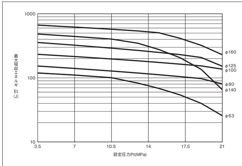
**PTT-2B A ロッド ロッド側最大吸収エネルギー**
