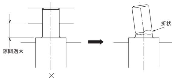
トラニオンと相手軸受けとの隙間をできるだけ小さくして取付けてください。また、軸受けとピンとの間に曲モーメントがかからないよう軸芯を一致させて取付けてください。
